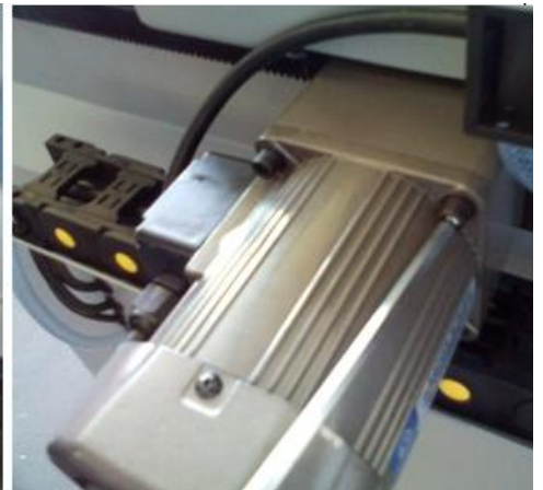
12. Moteur d'avance Poser avec 4 vis
