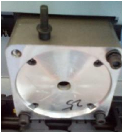
12. Moteur d'avance Poser avec 4 vis
