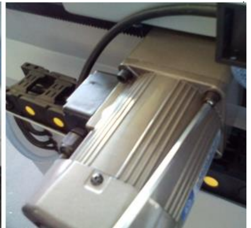
2. Vorschubmotor Mit 4 Schrauben montieren
