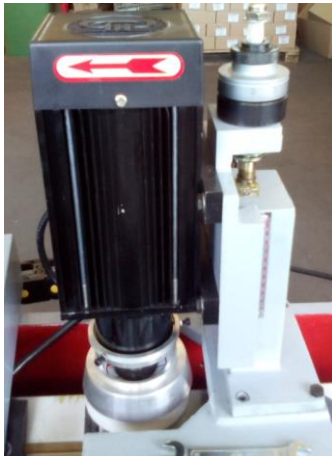
1. Hauptmotor: Mit 4 Schrauben montieren
