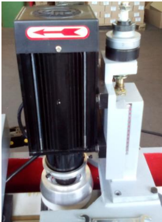
11. Moteur principal : Poser avec 4 vis
