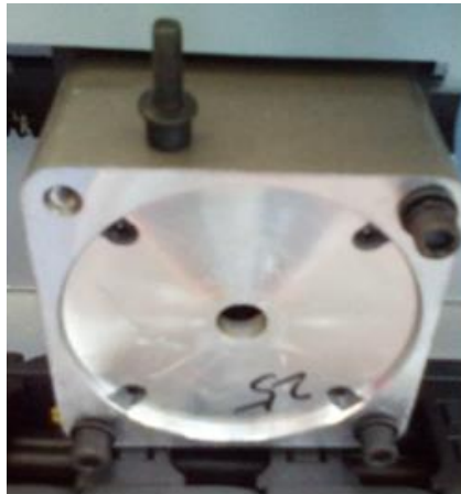
2. Vorschubmotor Mit 4 Schrauben montieren
