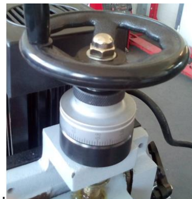
15. Volant : Installer le volant de réglage sur le filetage et le fixer avec le boulon
